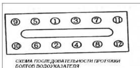
СХЕМА ПОСЛЕДОВАТЕЛЬНОСТИ ПРЯЖКИ
