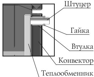
Рисунок 17. Демонтаж теплообменника.
