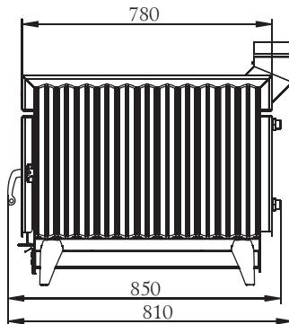
Рисунок 7. Габаритные размеры «Огонь-батарея 11Б» с выходом для трубы вверх.
