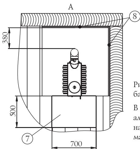
Рисунок 13. Монтаж печи «Огонь-батарея 7».
