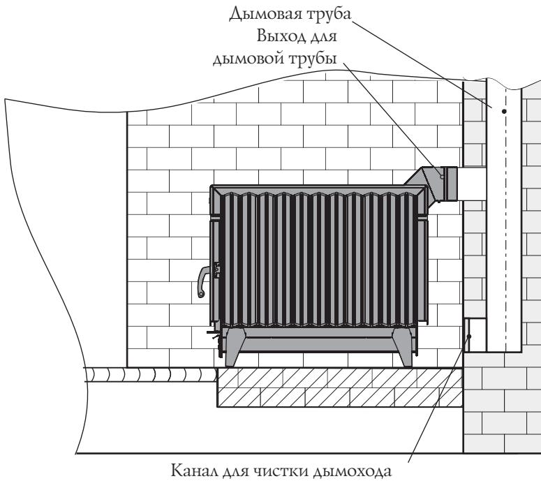
Рисунок 15. Схема присоединения печи к стационарному дымоходу из кирпича в помещении из негорючего материала.
