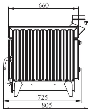
Рисунок 5. Габаритные размеры «Огонь-батарея 9Б» с выходом для трубы вверх.
