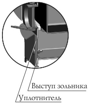
Рисунок 10. Выдвижной герметичный зольный ящик.
